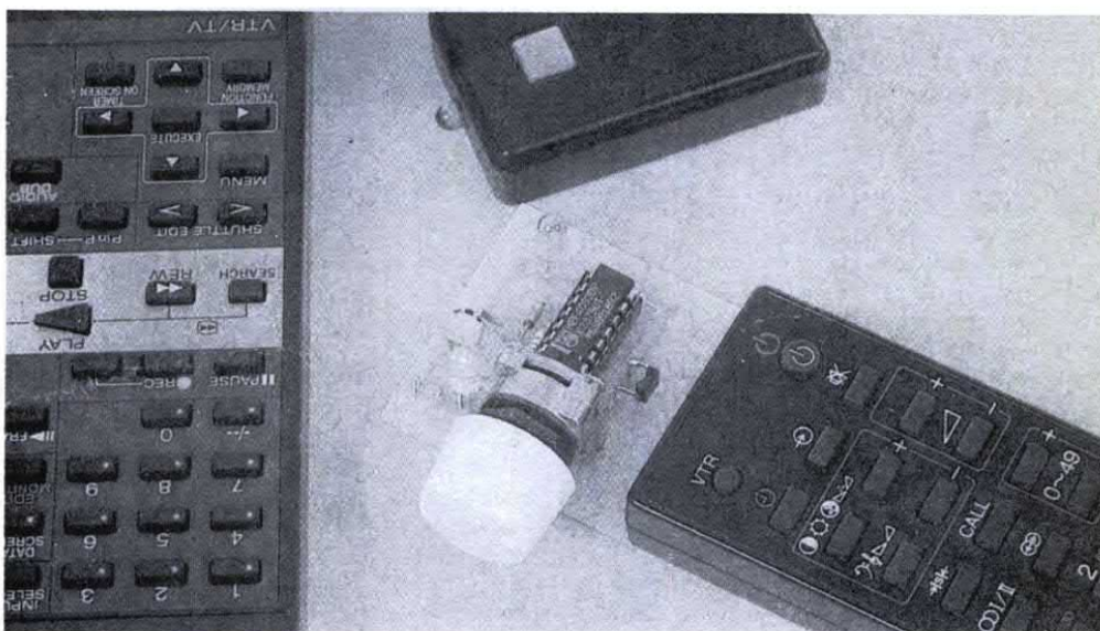
Figura 3. Disposizione dei componenti sulla basetta. Il diodo D1 va montato nel modo mostrato in figura.
