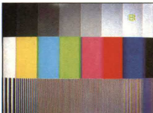
Monoscopia di definizione, colore e scala dei grigi del televisore Toshiba (PAL).
