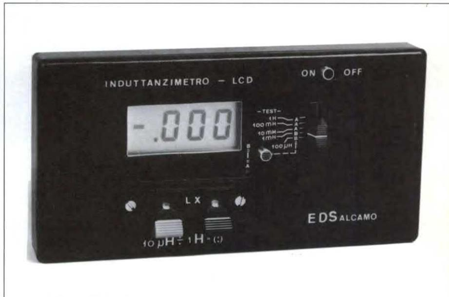
za con un campione dello stesso tipo, ma con una reattanza di segno opposto come quella fornita da un condensatore. Il circuito ponte consiste nell'adozione di una ulteriore amplificazione, di tipo selettivo effettuata da un circuito operativo sul segnale prelevato dalla prima diagonale del ponte.
