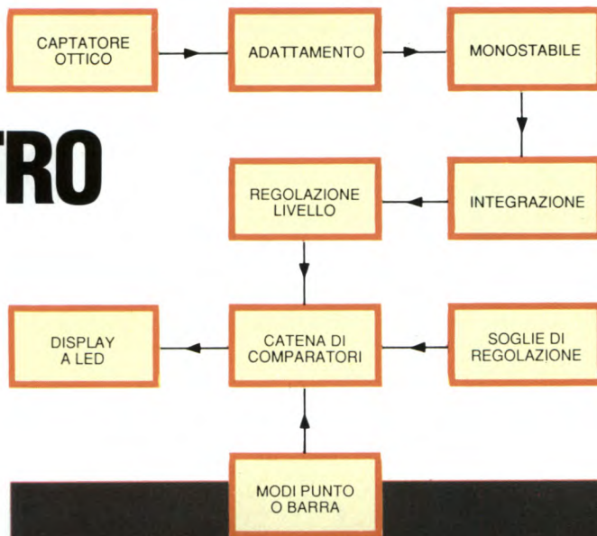
Figura 1. Schema a blocchi del circuito: i LED che indicano la forza del vento sono pilotati da una catena di comparatori, integrati in un LM 3914.
