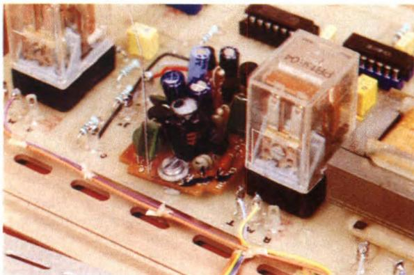
Poco dopo, C9 si carica attraverso R18 ed il livello "1" applicato all'ingresso di reset di IC4 azzerà quest'ultimo per iniziare un nuovo ciclo. All'impulso successivo, i monostabili partono ed IC4 raggiunge il conteggio 4, poi trasferito al flip flop.
