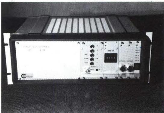
impulsi di tensione programmabili molto competitivi, che facilita le letture di tensione. Questo apparecchio è stato incorporato ad un sistema informatico di acquisizione di misure, per la caratterizzazione elettrica dei semiconduttori. E' destinato ai laboratori di elettronica e di microelettronica informatica.
