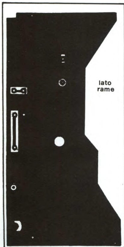
Figura 2. Circuiti stampati delle due basette visti in scala naturale. Quello di antenna è a doppio rame.
