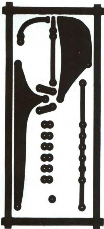
Figura 3. Circuito stampato del NiCd charger visto dal lato rame in scala naturale.
