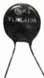
Figura 3 : Sembra un condensatore a disco, ma è in realtà un varistor ad ossido metallico che limita i picchi di tensione provenienti dalla rete a circa 180 V.
