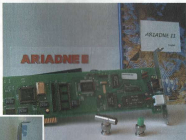
"Il contenuto della confezione: manuale, connettore a "T", terminatore e dischetti d'installazione.
