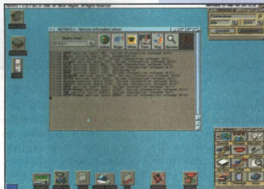
Il NetInfo controlla anche la porta del NetBios di Windows (la famigerata 139).
